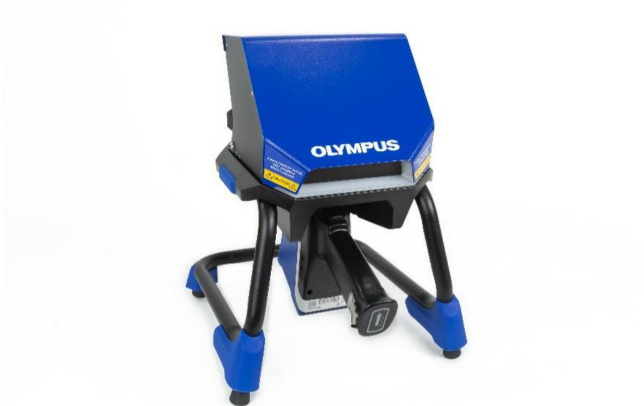
Die Röntgenfluoreszenzanalyse (RFA) ist für diese Anwendung besonders nützlich, da sie Schwermetalle, wie Blei, Cadmium und Quecksilber, in Kosmetik- und Hautpflegeprodukten ermitteln kann. Die Analyse erfolgt zerstörungsfrei und liefert zudem schnelle und genaue Screening-Ergebnisse.
